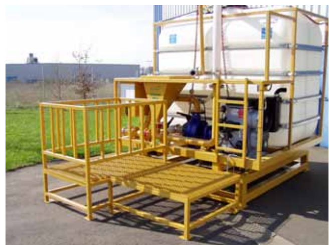
Anlage mit Podest und Bentonitsackhalter
