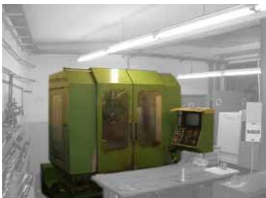
**Universal-Werkzeugfräs- und Bohrmaschine
